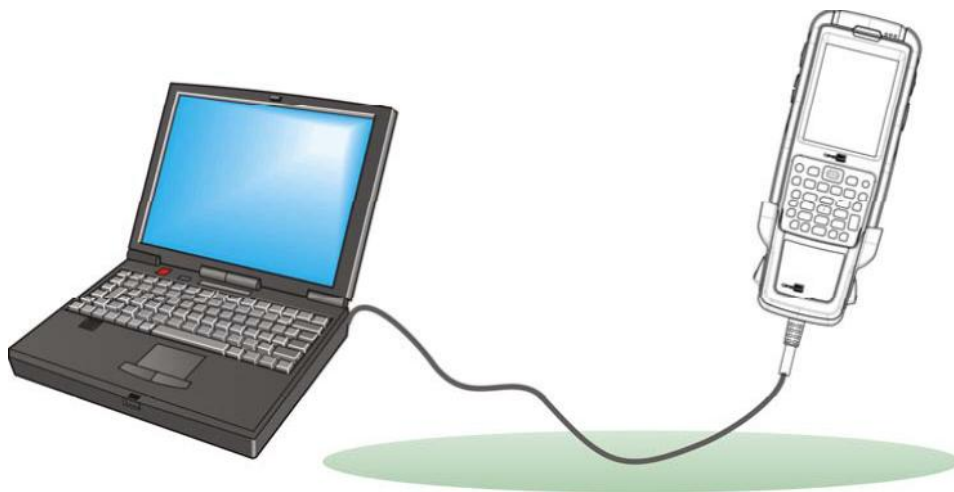
Рисунок 11: Прямая передача данных при помощи USB-кабеля.
