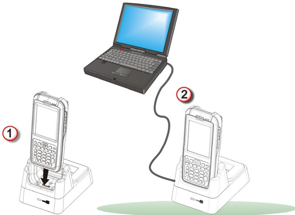
Рисунок 12: Прямая передача данных при помощи подставки
