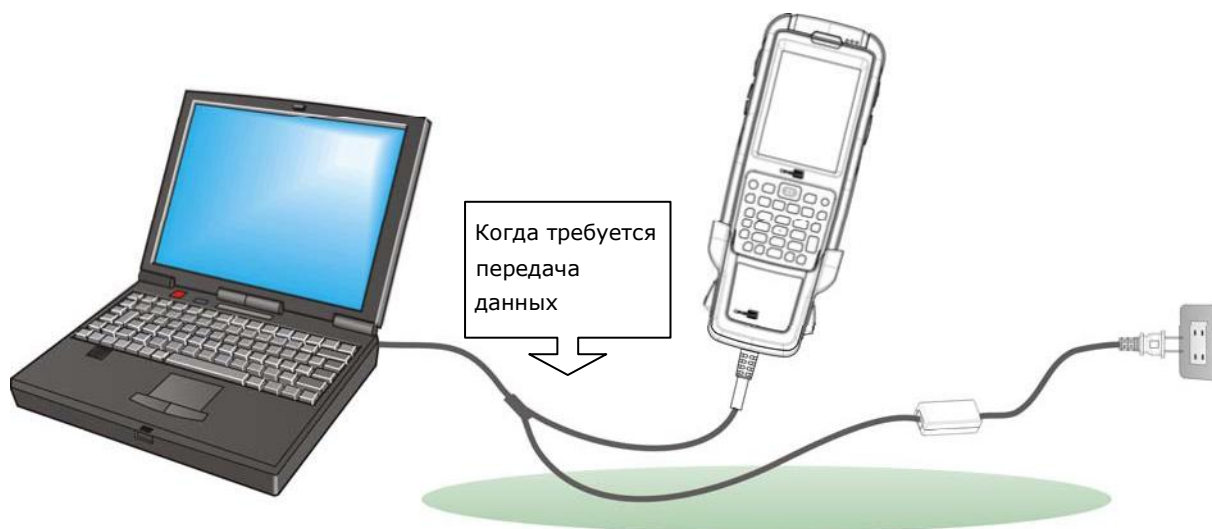
Рисунок 5: Прямая зарядка при использовании кабеля
